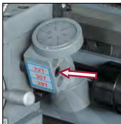
Figura 24 – Comparatore di filettatura e relativa tabella delle filettature
