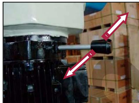
Figura 9 - Leva movimento motore.
