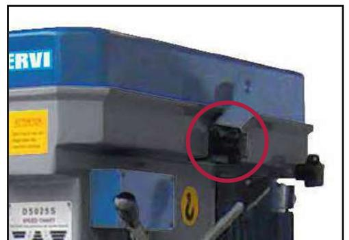
Figura 8 – Manopola bloccaggio puleggia.
