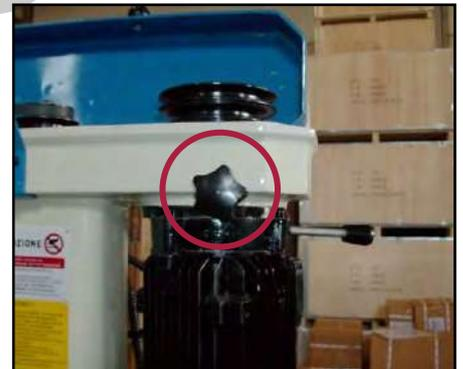
Figura 7 – Manopola di bloccaggio motore.
