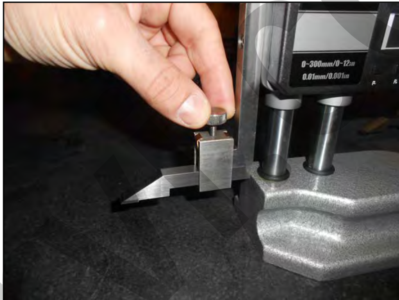
Figura 1 – Montaggio della punta da tracciare.
