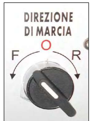
Figura 7 - Selettore verso di rotazione del mandrino.
