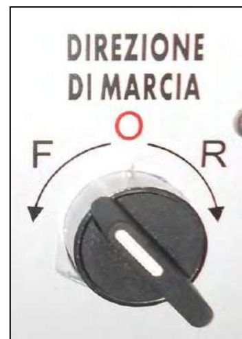
Figura 7 – Selettore verso di rotazione del mandrino.
