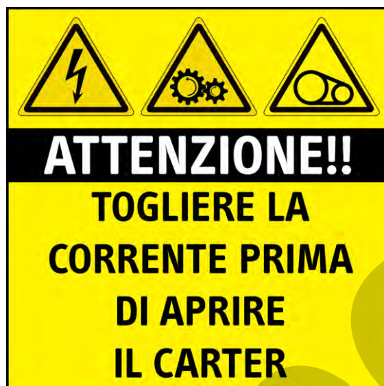
Figura 18 – Pittogramma sul carter di trasmissione.
