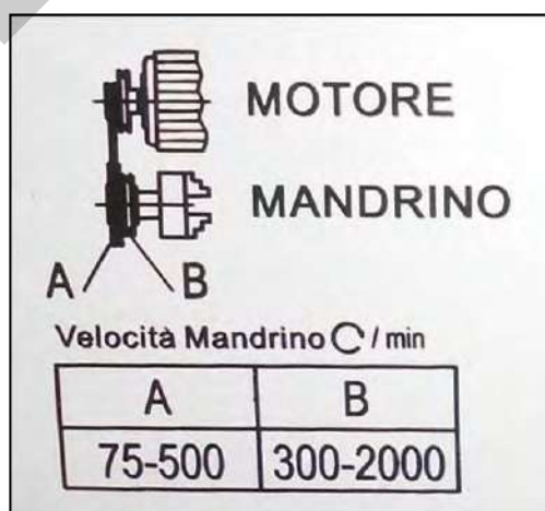
Figura 5 – Targa per la regolazione della velocità.
