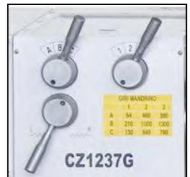
Figura 4 – Leve regolazione velocità.
