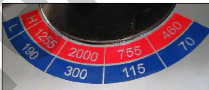
Figura 19 – Manopole di regolazione della velocità.
