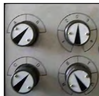
Figura 19 – Manopole di regolazione della velocità.
