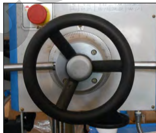
Figura 13 - Volantino di avanzamento orizzontale.
