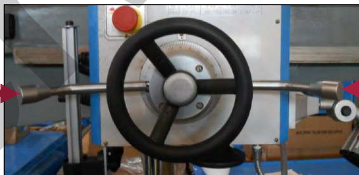
Figura 11 – Volantino di avanzamento mandrino.
