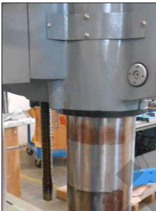
Figura 21 – Barra finecorsa testa.
