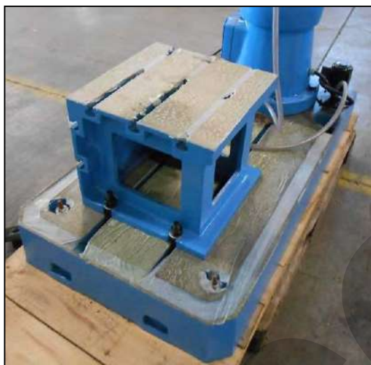
Figura 24 – Fissaggio al pavimento.
