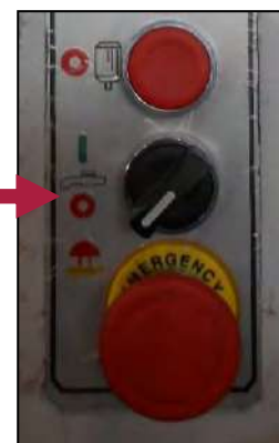
Figura 18 - Selettore per l'attivazione della pompa di aspirazione del liquido refrigerante.
