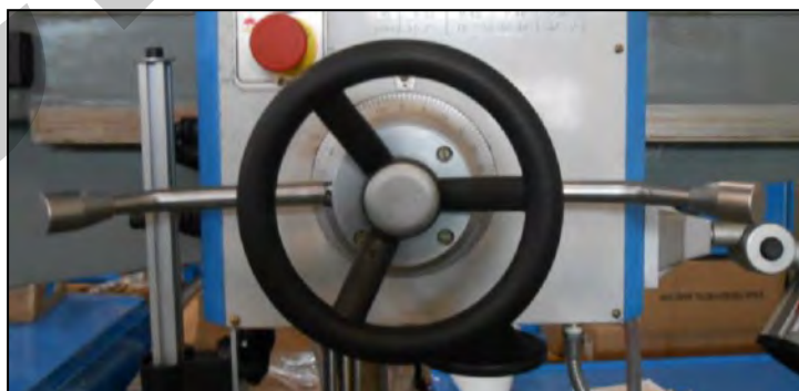
Figura 26 - Volantino di avanzamento e nonio posteriore.
