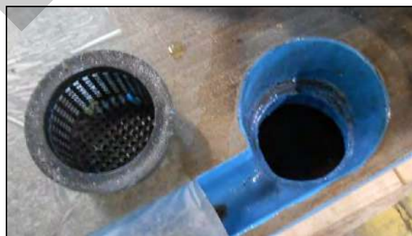
Figura 17 - Foro di ingresso liquido di raffreddamento.
