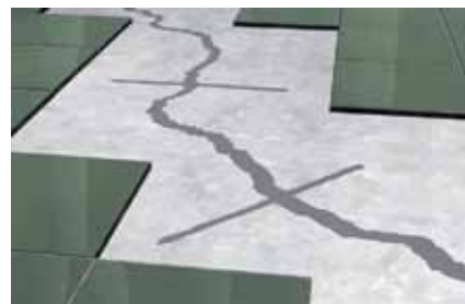
Sigillatura di fessure
