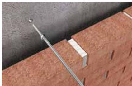
Dettaglio: installazione fissaggio di trattenimento
